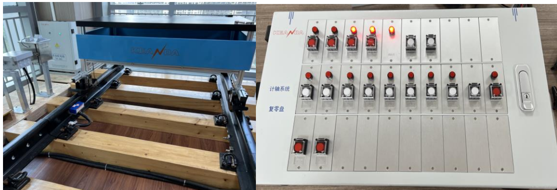
图 2 科安达核心产品——信号计轴系统
